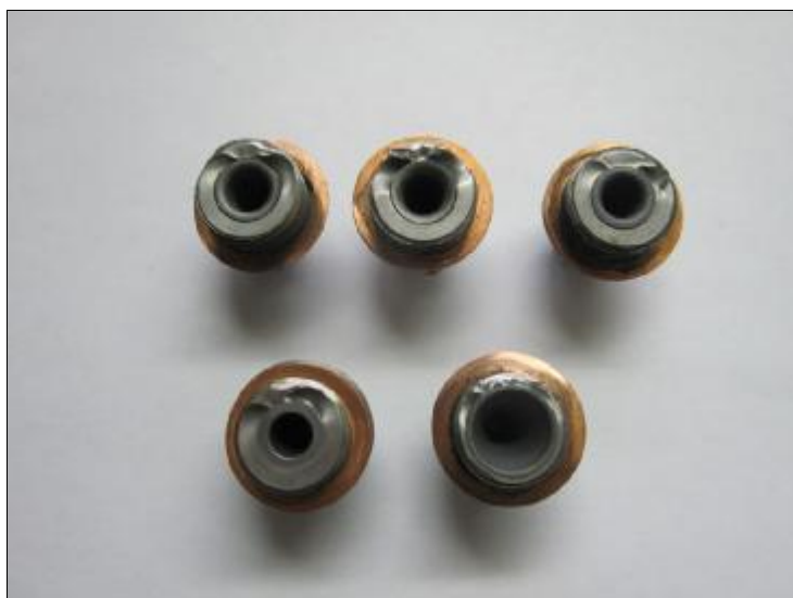
Рис. 7. Износ корпусов форсунок после промышленных испытаний.
