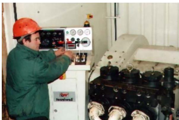
Фото 4. Цементируочный насос фирмы ТЕСНИВЕЛ ТW351.
