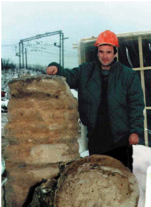
Фото 6. Вид грунтоцементной сваи.
