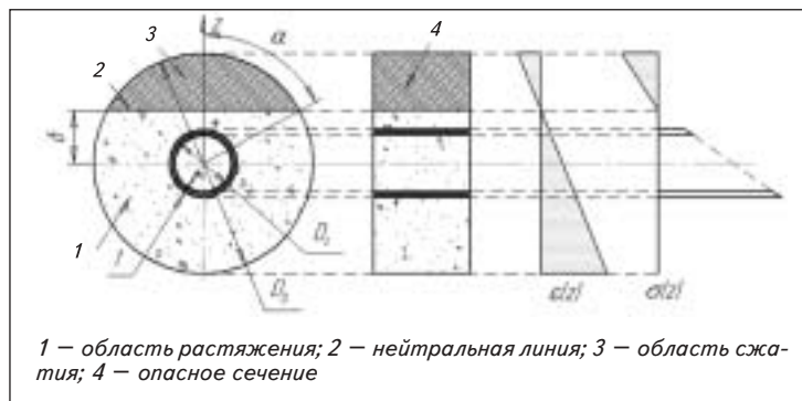
Рис. 2. Распределение деформаций и напряжений в сечении сваи по линейно-упругой модели
