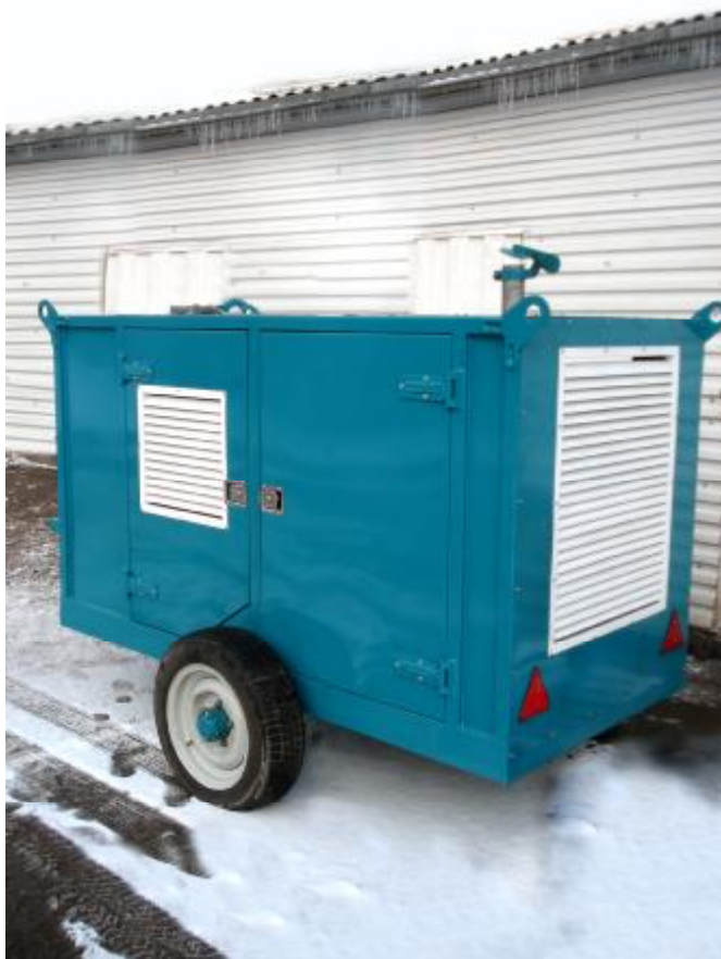
Рис.3. Внешний вид гидростанции.
