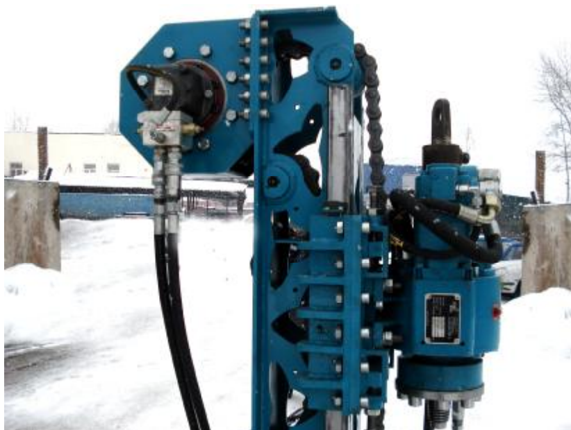
Рис.5. Планетарный редуктор с тяговым усилием 40 кН.
