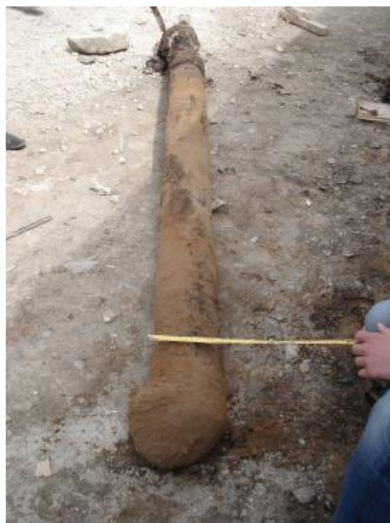
Рис.4. Откопанная опытная анкерная свая «Атлант»
