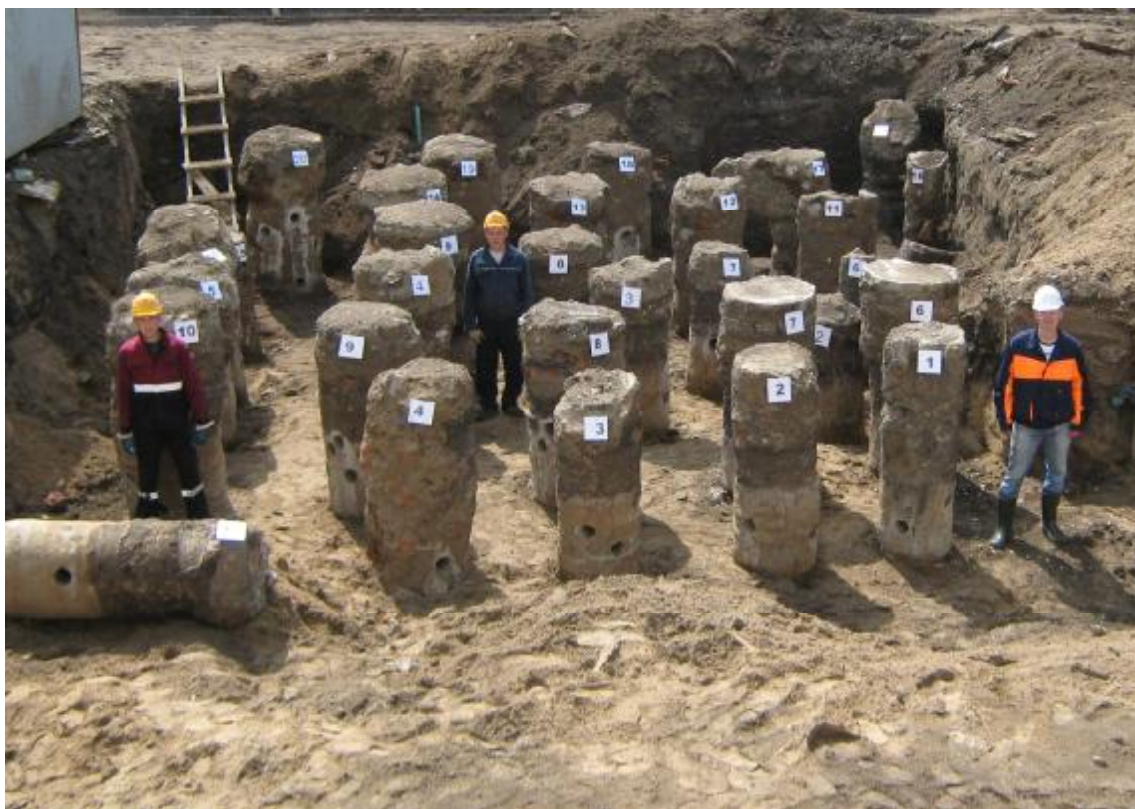
Рис. 5. Опытные грунтоцементные колонны
