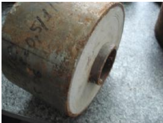
Рис.5. Характер разрушения контакта образца с гладкой трубой
