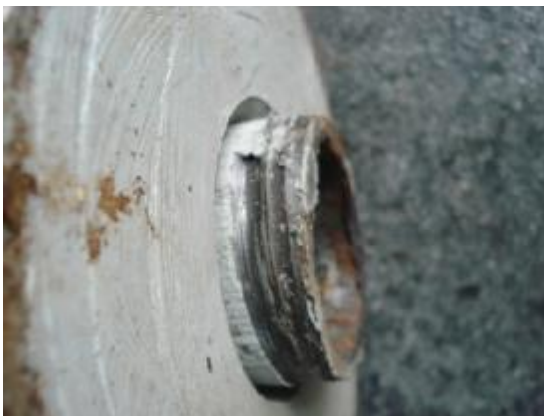
Рис.7. Характер разрушения контакта винтовой тяги
