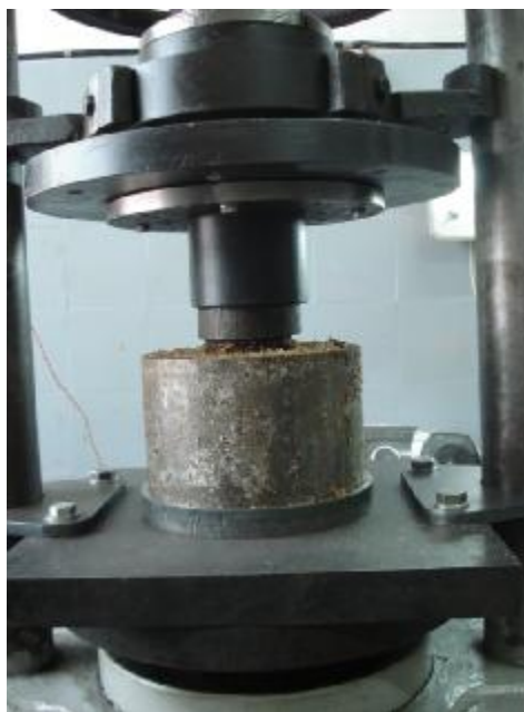
Рис.3. Испытательная установка на выдавливание трубы из цемента
