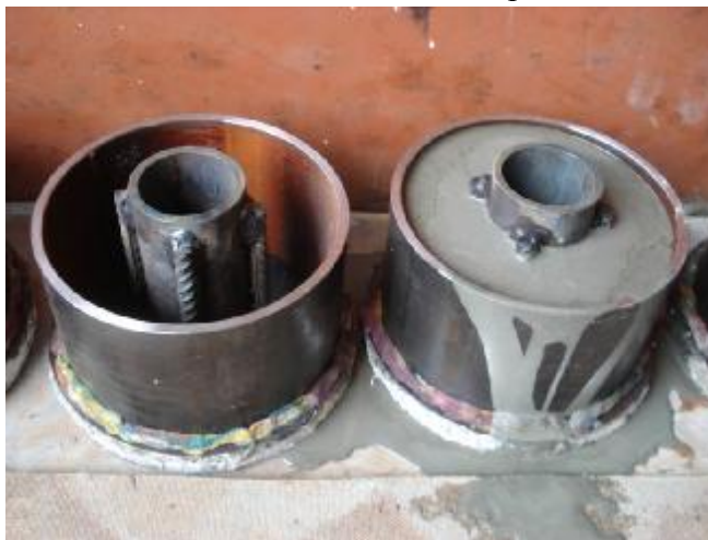
Рис.2. Внешний вид форм заливки образцов
