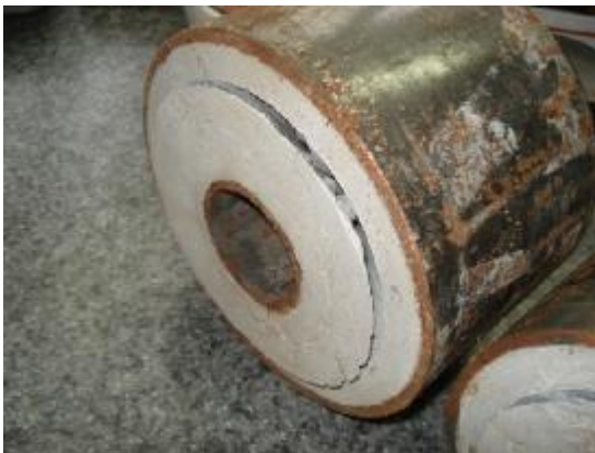
Рис.6. Характер разрушения образца с арматурными элементами
